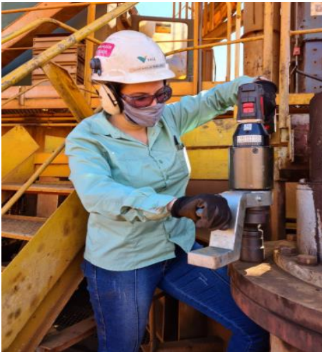
Abbildung 2: Eine Arbeiterin wartet eine Maschine mit einem alkitronic® Drehmomentschrauber der EAF-Serie
