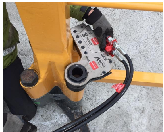
Abbildung 4: Hydraulikschrauber alkitronic® X-Driver 8 mit A-Drive SW 70
