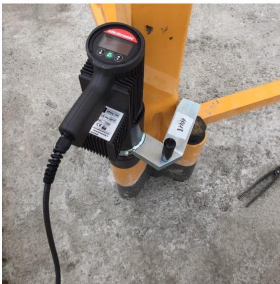
Abbildung 2: alkitronic® EFCip 100 mit Sonderabstützung
