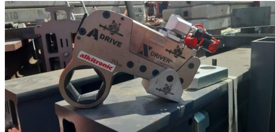
Abbildung 4: Der alkitronic X Driver ist mit seiner flachen Bauweise ideal für die Arbeit in engen Platzverhältnissen.
