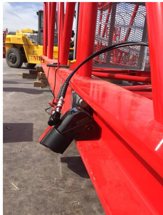
Abbildung 3: Test mit dem hydraulischen Schrauber AT von alkitronic.
