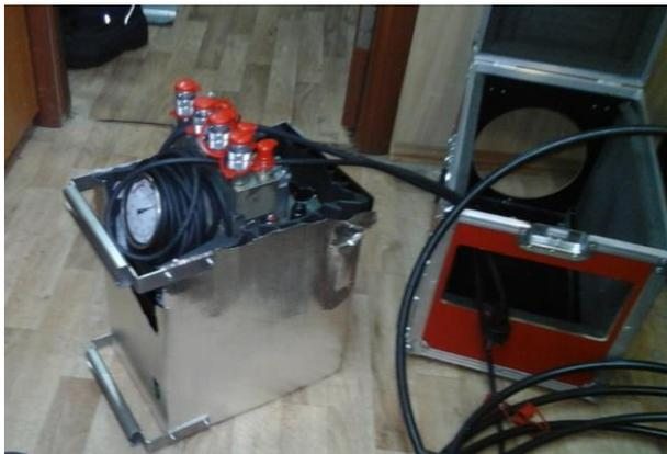
Abbildung 5: alkitronic Pumpe Nova mit zusätzlichem Isolierkasten
