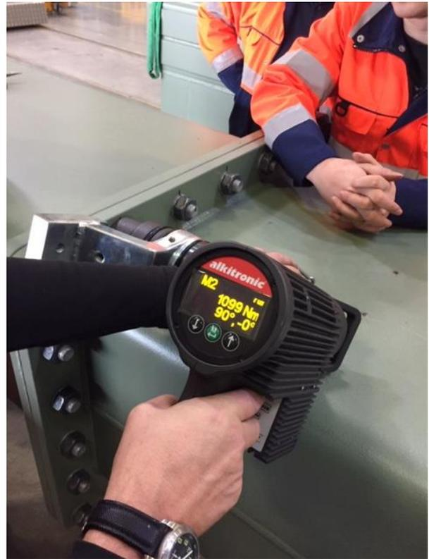
Abbildung 3: Verschrauben nach dem Drehmoment-/Drehwinkelverfahren
